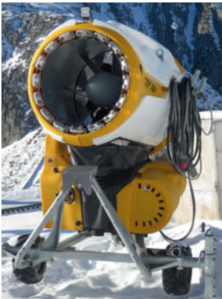
Schneekanone am Nätschen. Für den Betrieb des Schneeerzeugers braucht es Wasser und Energie.
